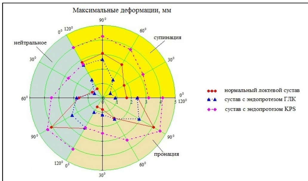
рис. 3.28. Поля максимальних деформацій для різних положень передпліччя.
