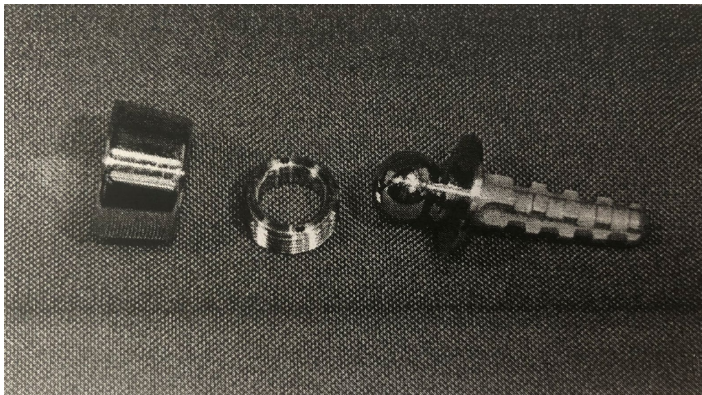
рис. 4.5. Розроблений безцементний модульний біполярний ендопротез голівки променевої кістки (Патент України №83334) в розібраному вигляді.
