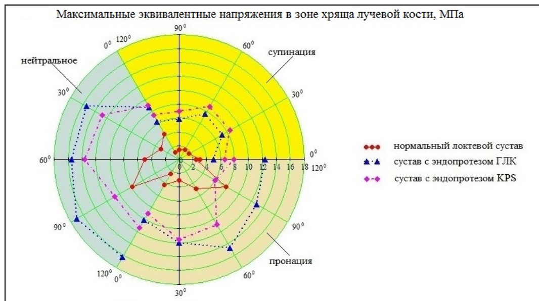
рис. 3.29. Поля максимальних напружень в зоні контакту хряща променевої кістки для різних положень передпліччя.
